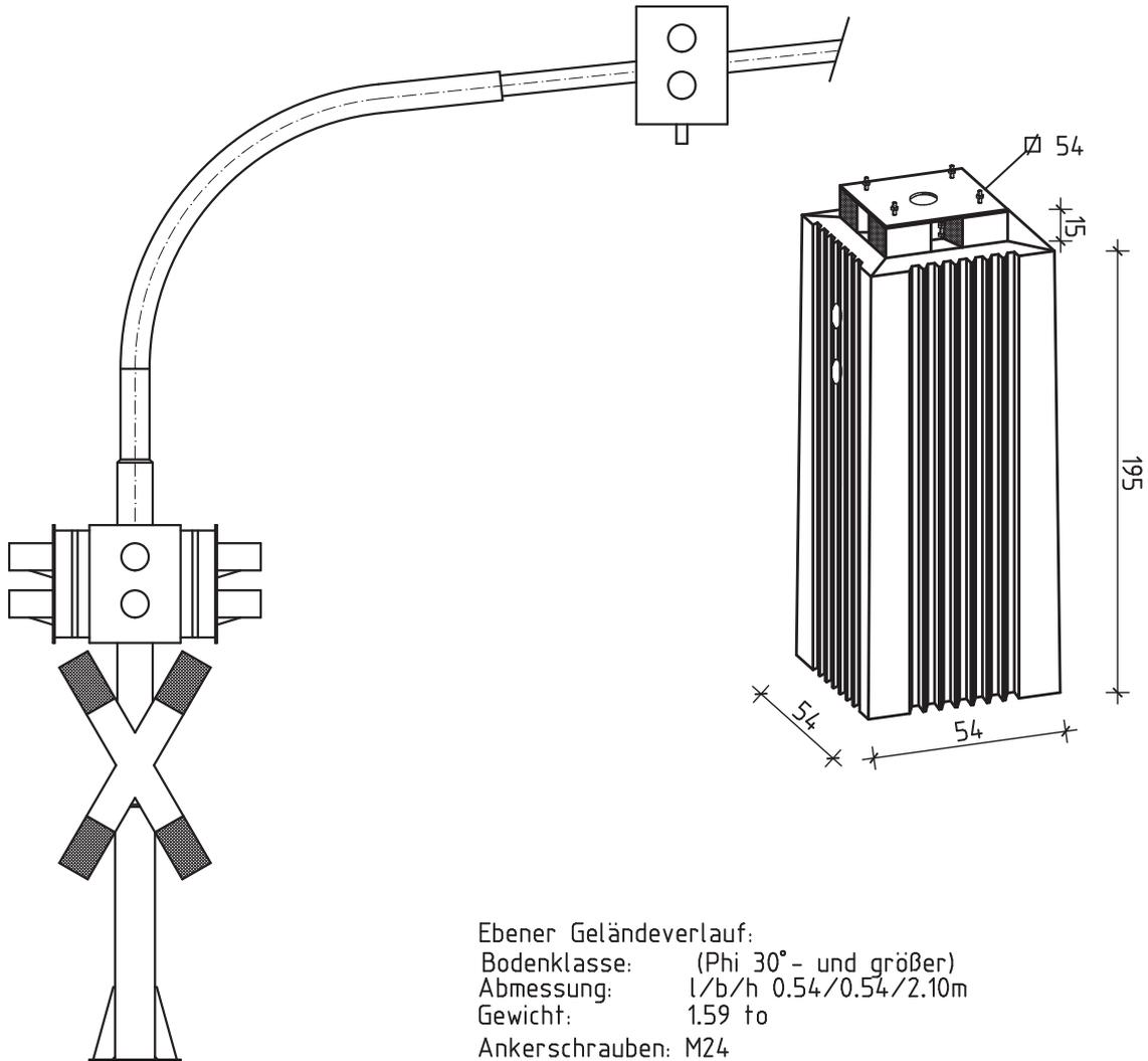
Fertigteilfundament für Peitschenmast bis 6,25m Ausleger
