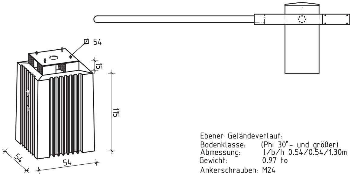
Fertigteilfundament für Schrankenbetrieb Baumlänge 7.0 bis 10.0m
