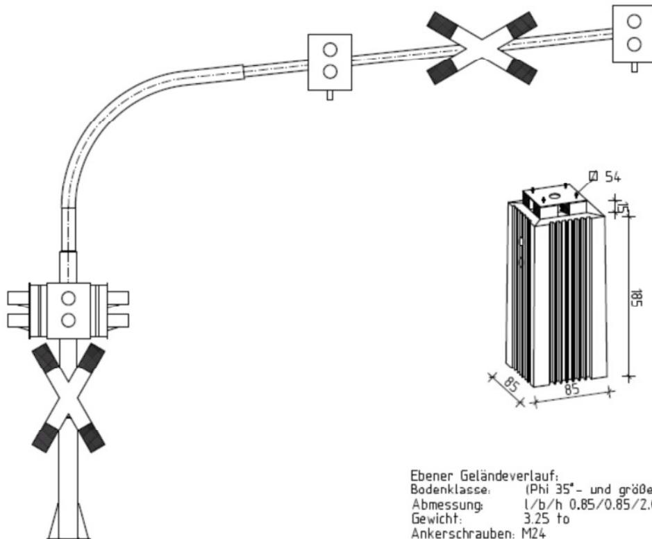
Fertigteilfundament für Streckensignale mit Vorsignal
