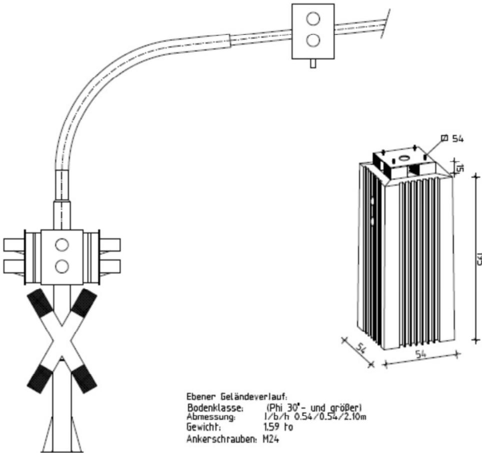
Fertigteilfundament für Peitschenmast bis 6,25m Ausleger
