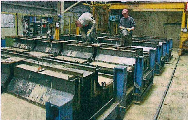
Hier entstehen die Betonteile: Die Formen werden mit dem Baustoff gefüllt, die Fertigteile anschließend ausgeschalt und zum Aushärten gelagert.
